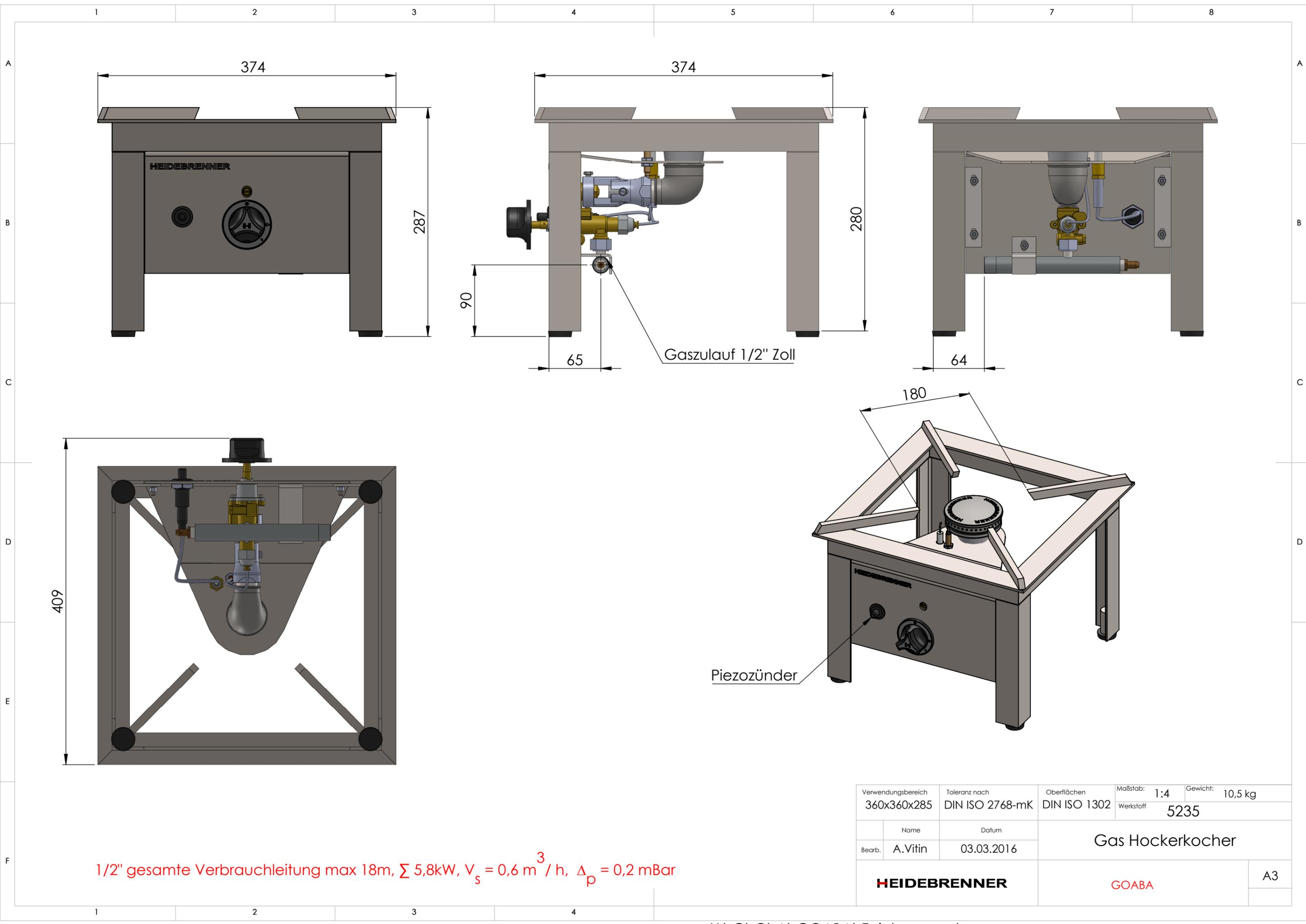
1/2" gesamte Verbrauchleitung max 18m,  $\Sigma 5,8kW$ ,  $V_s = 0,6 \text{ m}^3 / \text{h}$ ,  $\Delta_p = 0,2 \text{ mBar}$
